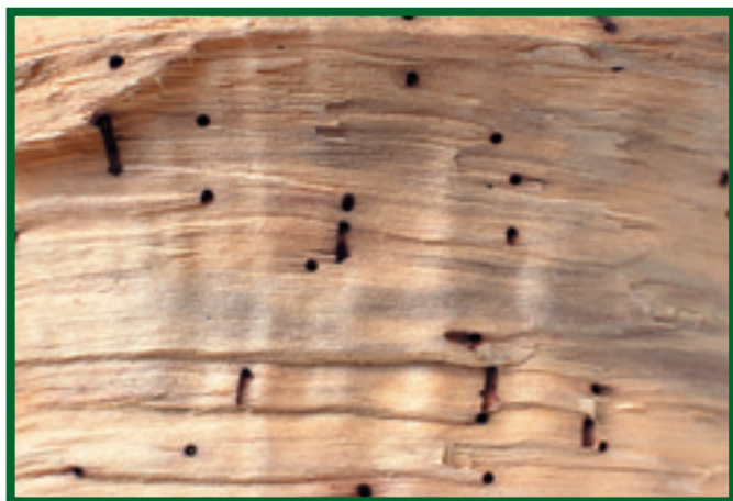
Požerky dřevokaza v různě orientovaných řezech smrkovým dřevem
