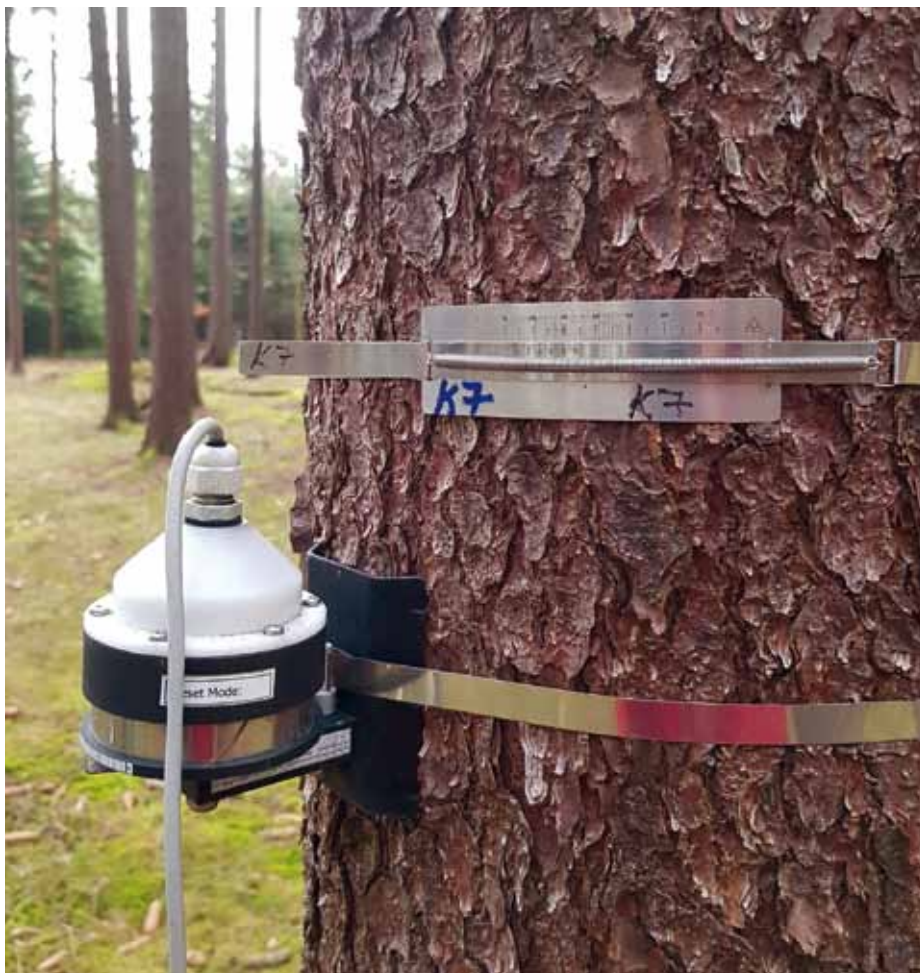
Obr. 1: Elektronický dendrometr DR 26 (dole) a pásový dendrometr s manuálním odečtem DB 20 (nahore), instalované na kmeni smrku na ploše intenzivního monitoringu I140 Želivka. Foto: autor
