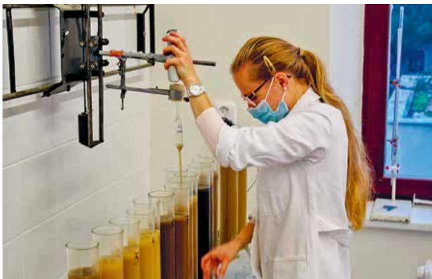
Stanovení zrnitostního složení půdy tzv. sedimentační metodou.
