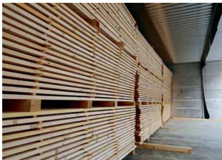
Řezivo zavezené do komory sušárny a připravené k procesu sušení.
