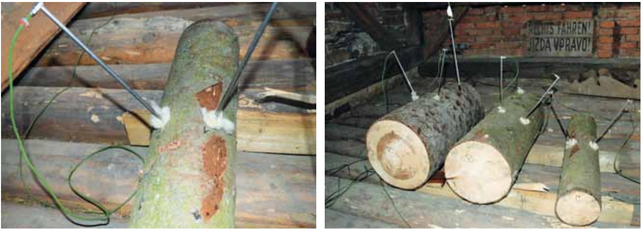
Obr. 2: Fotodokumentace umístění termoelektrických snímačů ve zkoumaných vzorcích.
